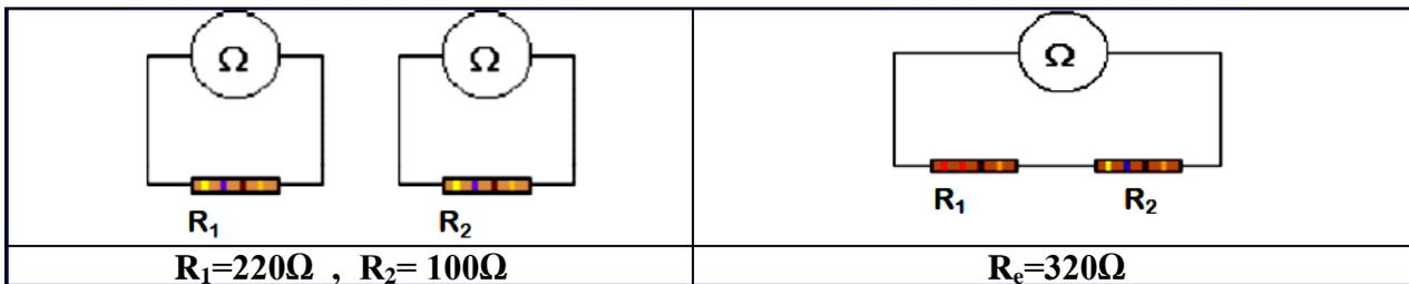
c- **Conclusion** : Deux conducteurs ohmiques de résistances R<sub>1</sub> et R<sub>2</sub> associés en série sont équivalents à un conducteur ohmique de résistance  $R=R_1+R_2$ .
