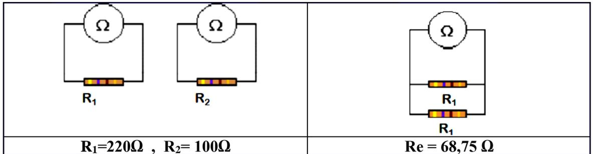
**b- Conclusion :** Deux conducteurs ohmiques de résistances  $R_1$  et  $R_2$  associés en dérivation sont équivalents à un conducteur ohmique de résistance telle que:
